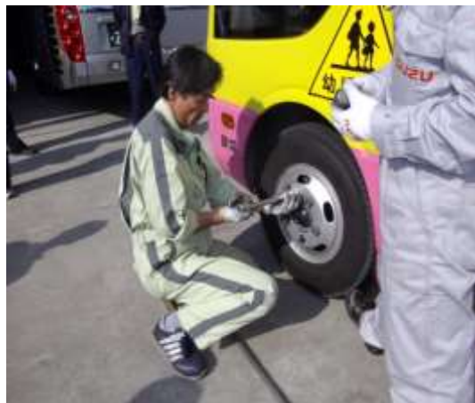
ボルトの規定締め付けの実習
